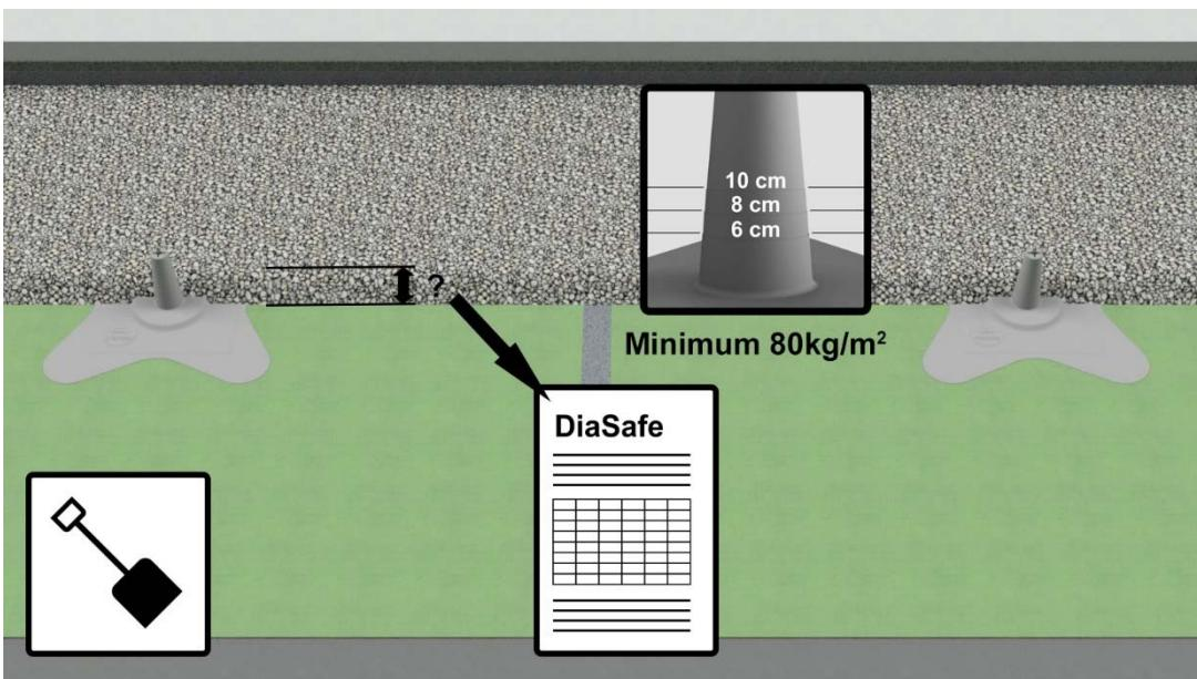
Open linesystem installation (with start- and end posts) / Montageablauf offenes Seilsystem (mit Anfangs- und Endstütze) / Installation d'un système ouvert (avec Start- et Fin potelet) / Montaggio sistema aperto (con colonna iniziale e terminale) / Nyílt rendszer telepítése (kezdtő- és végszloppal)
